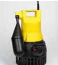
Für fäkalienfreies Abwasser mit Korngrößen bis 10 mm, bei abgenommenem Siebfuß bis zu 20 mm. Für häusliche Entwässerungsgegenstände wie Geschirrspüler und Waschmaschinen.
