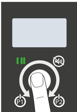
Die einzelnen Menüpunkte / Parameter werden mit dem Drehtaster eingestellt.
