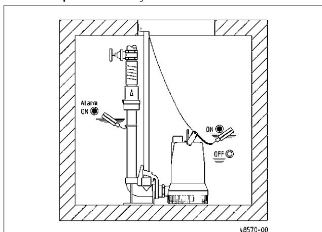
**Montage:** Den Kupplungsfuß fest auf dem Boden des Sammelschachtes verdübeln und dann das Gleitrohr montieren. Danach die Druckleitung einschließlich der erforderlichen Armaturen wie Rückschlagklappe und Absperrschieber einbauen.
