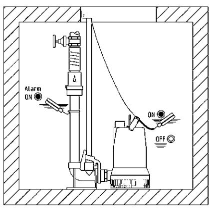
**Montaggio:** Fissare con tasselli il piede di raccordo al pavimento del pozzetto di raccolta, quindi montare il tubo scorrevole. Quindi installare la linea di mandata comprensiva di valvole necessarie, come la valvola di non ritorno e di bloccaggio.
