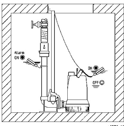
**Montage:** De koppelingsvoet stevig met pluggen op de bodem van de verzamelpunt vastzetten en vervolgens de schuivende buis monteren. Vervolgens de drukleiding met de nodige hulpsukken zoals terugslagklep en afsluiter monteren.
