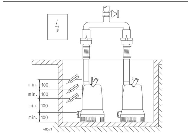
**ATTENTIE!** De vlotters van de niveau- en alarmschakeling worden vrij beweegbaar ingebouwd, maar dit mag niet onder de inlaat. Neem de minimale afstanden in acht. De regelaar alleen in een droge en goed geventileerde ruimte installeren!
