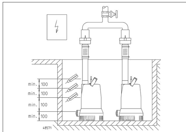
**NOTYFIKACJA!** Pływaki sygnalizacji poziomu i alarmu montować swobodnie, lecz nigdy nie pod dopływem do pompy. Prosimy przestrzegać minimalnych odstępów. Sterowniki prosimy montować wyłącznie w suchych i dobrze wentylowanych pomieszczeniach!
