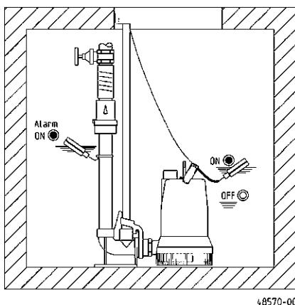
**Montáž:** Spojovací patku pevně připevnit pomocí hmoždinek na dno sběrné šachty a potom namontovat posunovací trubku. Potom namontovat tlakové potrubí včetně potřebných armatur, jako je zpětná klapka a uzavírací šoupátko.
