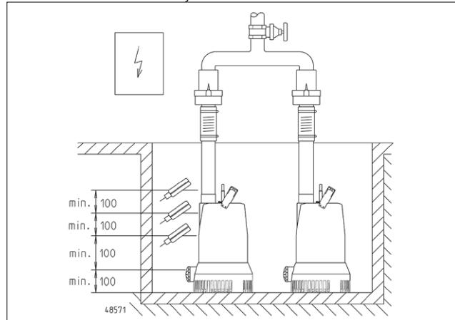
**ODZÁDZKOVÝ SPÍNAČ!** Plaváky hladinového a poplachového spínania sa zabudujú voľne pohyblivo, nie však pod prítokom. Dodržiavajte minimálne vzdialenosť! Riadenie inštalujte len v suchej a dobre vetranej miestnosti!
