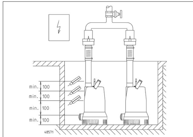
**ÉRTESENÍTÉS!** A szint- és riasztási kapcsolók úszót szabadon mozgathatóan kell beépíteni, de nem a befolyási oldalon. Kérjük, tartsa be az előírt minimális távolságokat. A vezérlőt csak száraz és jól szellőző térben telepítse!
