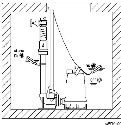
**Montáž:** Spojovaci pätku upevnite pevne o dno zbernej šachty príchytkami a následne namontujte klznú rúru. Potom zabudujte výtlacné vedenie vrátane potrebných armatúr ako napr. spätnú klapku a posuvný uzáver.
