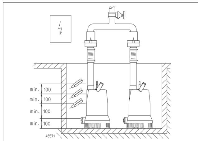
**HINWEIS!** Die Schwimmer der Niveau- und Alarmschaltung frei beweglich einbauen, jedoch nicht unter dem Zulauf. Bitte die Mindestabstände beachten. Die Steuerung nur in einem trockenen und gut gelüfteten Raum installieren!
