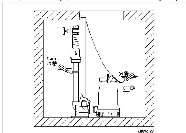
**Montage :** Cheviller fermement le pied d'assise au sol de la chambre collectrice et monter la barre de guidage. Monter ensuite la conduite de refoulement y compris les armatures nécessaires comme le clapet anti-retour et la vanne d'arrêt.
