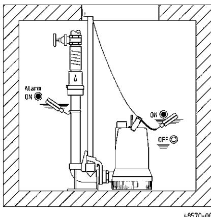
**Összeszerelés:** A kuplungtalpazatot a gyűjtőakna alapzatán kell peckekkel rögzíteni, eztán felszerelendő a csúsztatáocső. A nyomóvezeték beépítése a szükséges szerelvényekkel, mint amilyenek a visszacsapólemez és a lezáróretesz, ezután törtenhet.
