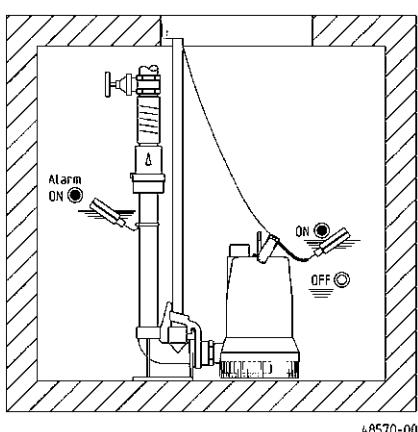
**Montaż:** Stopkę sprzęgła zakotwić w stabilny sposób do podłoga studzienki zbiorczej i zainstalować rurę tloczną. Następnie, wbudować przewód tloczny wraz z niezbędną armaturą jak klapa zwrotna i zasuwa odcinającą.
