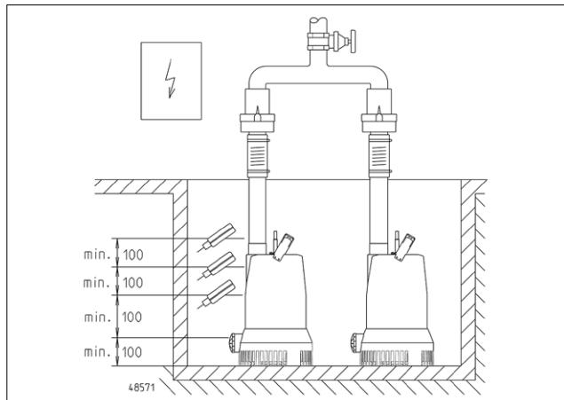
**AVIS !** Les flotteurs du dispositif d'alarme et du commutateur de niveau sont montés de façon mobile, cependant pas sous l'amenée. Veuillez observer les écarts minimum. Installer l'unité de commande dans une pièce sèche et bien ventilée !
